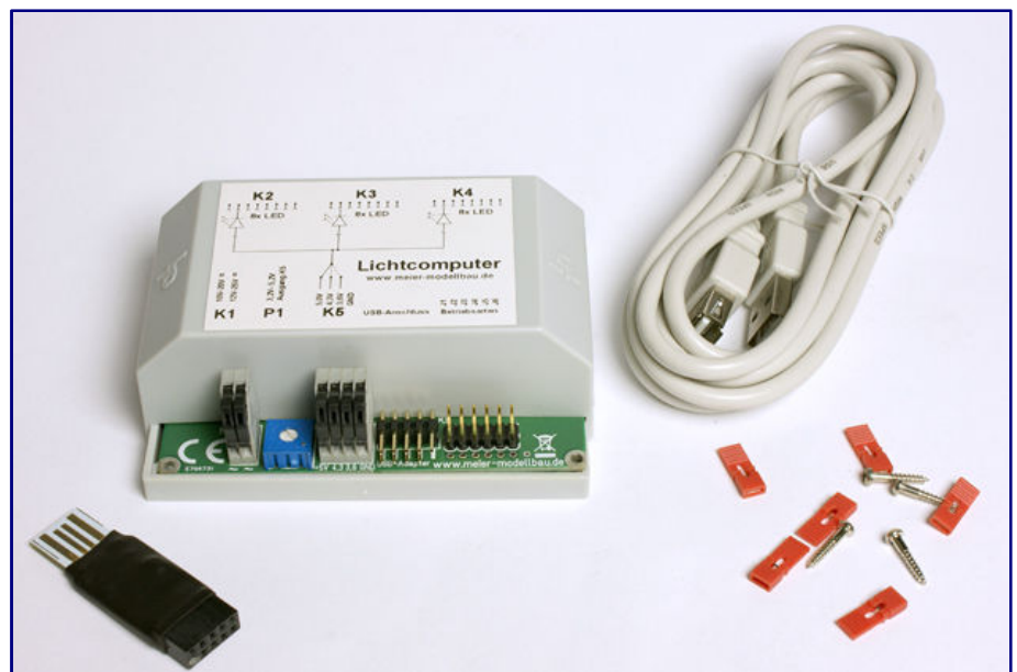
Zum Lieferumfang des Lichtcomputers von Meier-Modellbau gehören neben dem Baustein noch sechs rote Steckbrücken („Jumper“) und vier Schrauben zum Befestigen am Einbauort. Der USB-Adapter (vorne links) wird separat angeboten und ist zusammen mit einem USB-Kabel zur Verlängerung (hinten rechts) für Programmierungen am PC erforderlich.
