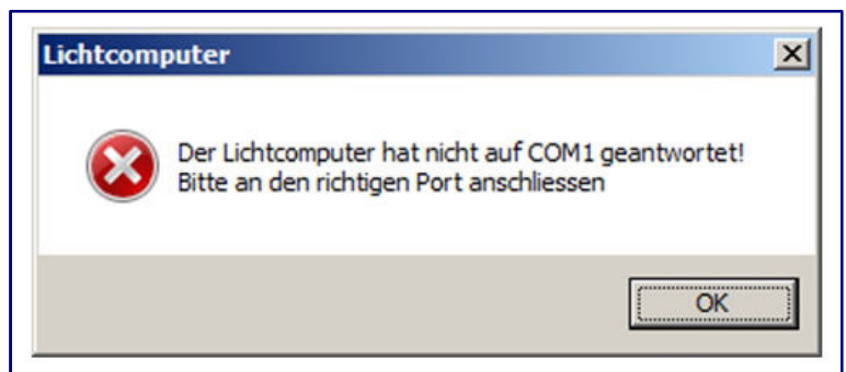
Wir der falsche Anschluss ausgewählt, gibt das Programm einen Fehlerhinweis aus. Abbildung (Handbuch): Meier-Modellbau
